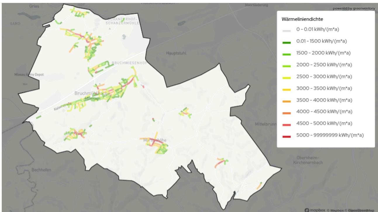
Abbildung 11: Wärmeliniedichten der einzelnen Straßenabschnitte
