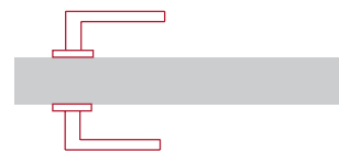
31 – 32 Geeignete Drückerformen – mit gebogenem und mit längerem Griffteil (U- und L-förmige Griffe)
